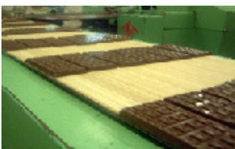
Os moldes submetem-se a uma série de vibraciones para eliminar as borbulhas que pudessem se ter formado ao cair a massa ao molde.
