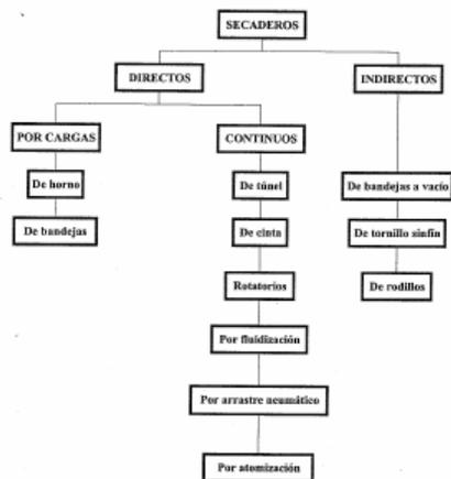
Figura 6.-Clasificación de los principales tipos de secaderos.
